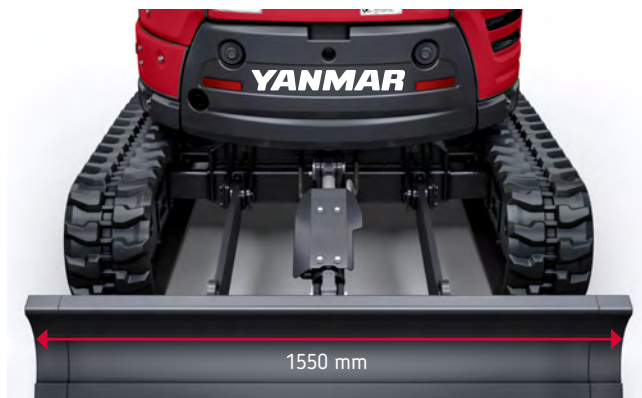
Utfällda: ökad stabilitet för förbättrad grävning och lastfunktion
