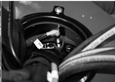
Fig. 105 Närhetsbrytare på lagerringen
